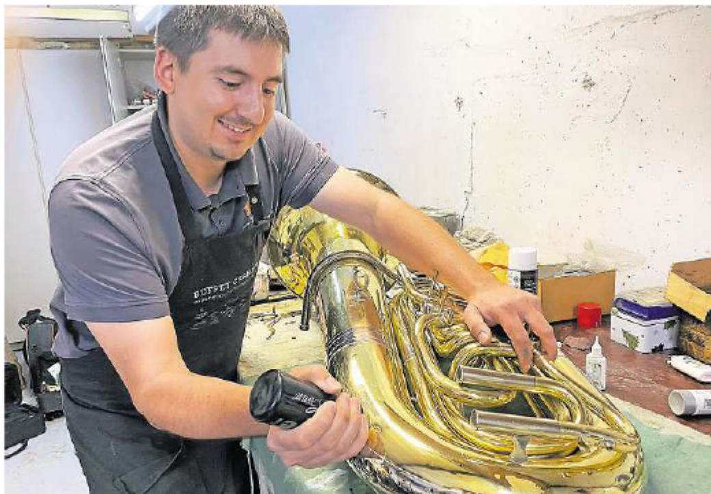
Mit einem starken Magneten arbeitet Patrick Knorr die Beulen sanft aus dem Metall.
