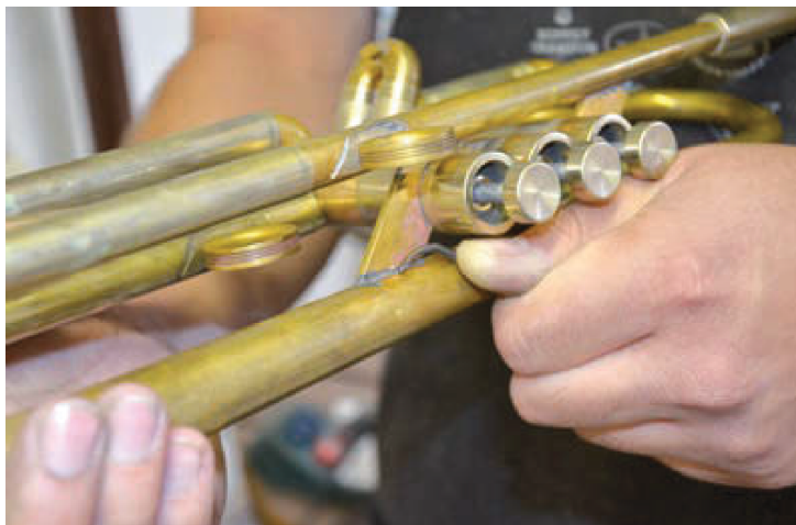
Abschaben von Lötmaterial mit Zinnschaber
