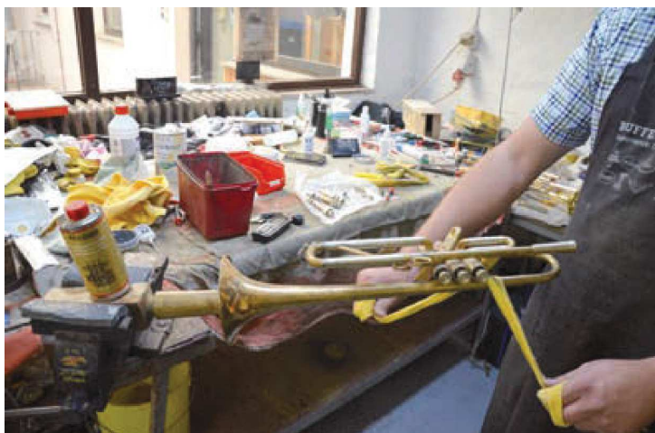
Politur der innenliegenden Flächen des Schallstücks
